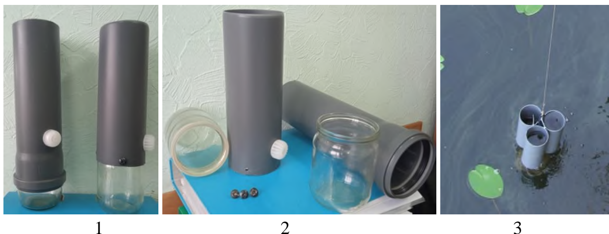
Рис. 2. Седиментаційні пастки: 1, 2 – два види седиментаційних стаканів у різних ракурсах, 3 – процес польових випробовувань пропонованого варіанту пасток
